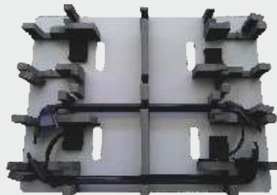
Stapeltray für Fensterdichtungen
