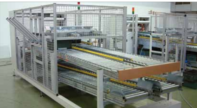
Behälter Füllanlage - verfahrbar
