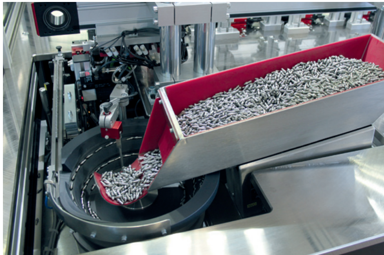
Die komplette, anschlussfertige Afag-Zuführstation für zwei Typen Stifte gemäss der Spezifikation von PB-Automation. (Bilder: Afag)
