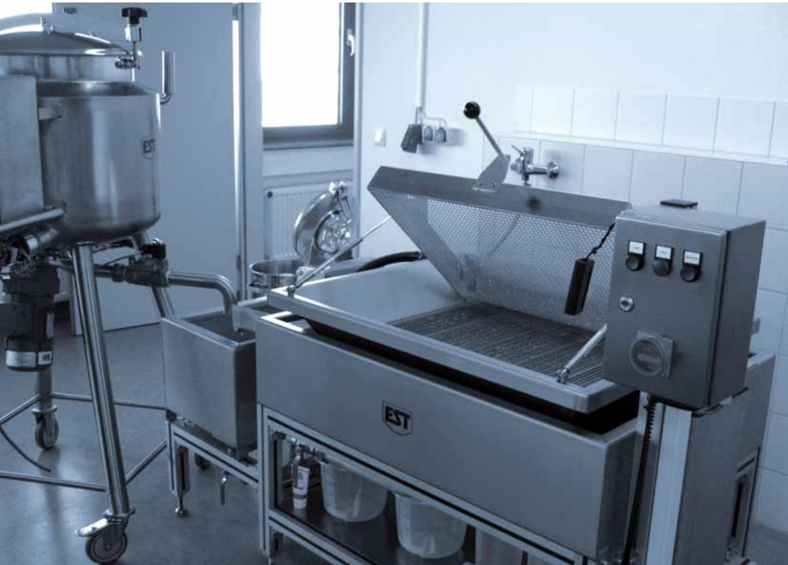
Faseraufbereitungsanlage am Anfasergerät
