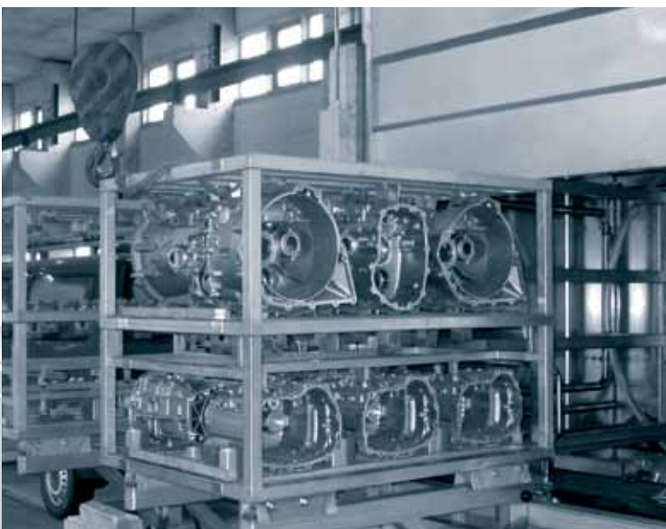
Detailansicht Verschiebegestell mit unterschiedlichen Waschboxen
