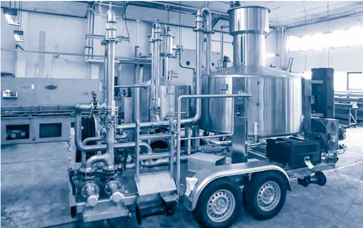
Mobile Prüfausrüstung nach ADR mit Pumpe und Schlauchaufroller, 500 bis 3.000 Liter Mobile testing equipment complying with ADR, with pumps and hose reels, 500 to 3,000 litres
