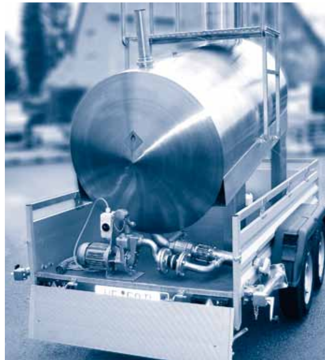
Eichkolben 2000 Liter liegend auf Hänger Prover gauges 2000 litres, with hanging hook
