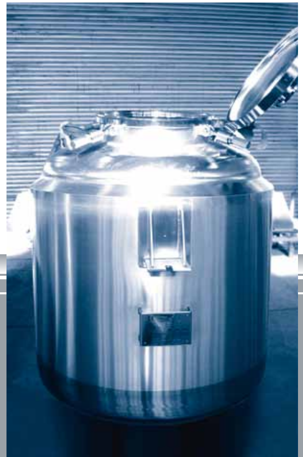
CIP-Behälter 400 l/600 l mit Isoliermantel, Werkst.: 1.4435 Ra 0,4 µm, Druck: 4,5 bar CIP container 400 l/600 l with isolating jacket. Material: 1,4435 Ra 0.4 µm, pressure: 4.5 bar
