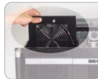
Easily replaced fan module
